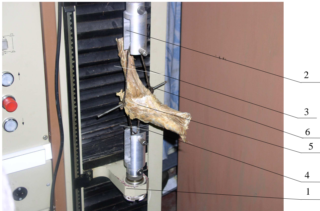
Рис. 3. Універсальна випробувальна машина TIRATEST-2151 з досліджуваним ліктьовим суглобом; 1 – рухома траверса; 2 – тяга, що з'єднана з динамометром; 3 – верхня тяга; 4 – нижня тяга; 5 – ліктьовий суглоб; 6 – імплантат (стрижень).
