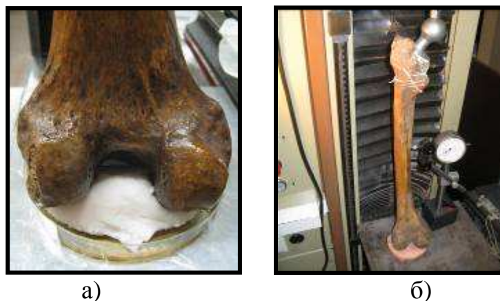
Рисунок 3 - Формование нижней опоры для испытаний бедренной кости при компрессионных нагрузках (а); размещение препарата на рабочем столе испытательной машины (б).
