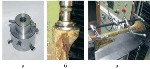
Рис. 2 — Захват в виде полого цилиндра для передачи на кость дистракционных, компрессионных и изгибных нагрузок (а); тарельчатая пластина для создания компрессионных нагрузок (б); препарат (большеберцовая кость с закрепленным стержневым аппаратом фиксации переломов), размещенный на рабочем столе испытательной машины (в)
