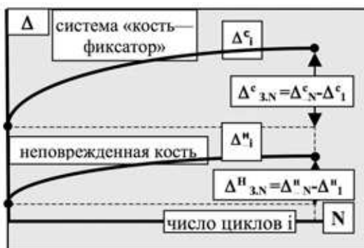
Рис. 5. Накопление «задержанных» деформаций при циклическом нагружении неповрежденной кости и системы «К–Ф»
