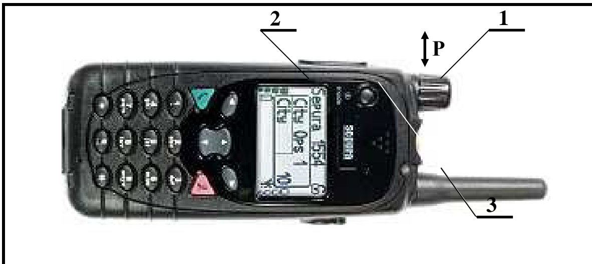
Рис. 1. Абонентська радіостанція та елементи, що піддавали навантаженням при випробуваннях: 1 - перемикач роторного типу; 2 - дисплей; 3 - кнопки "On/Off".
