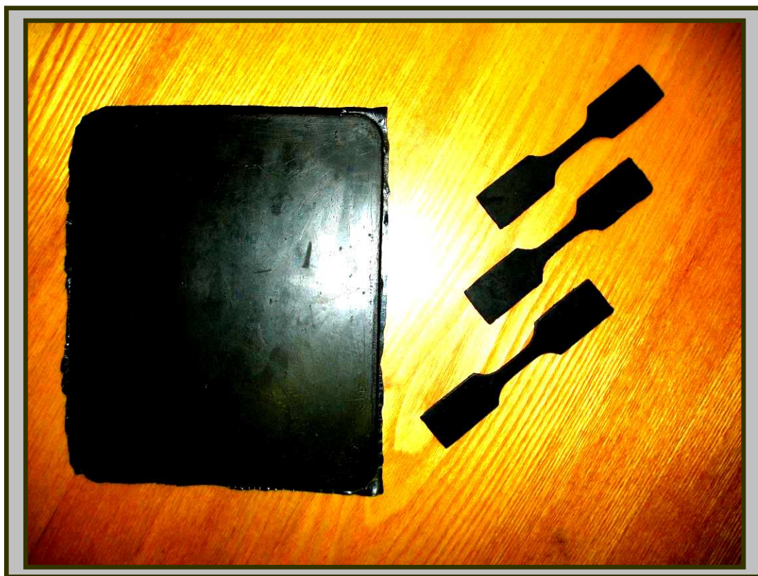
Рис. 6. Гумова пластина та зразки, виготовлені за стандартом [17], для випробувань на розтяг
