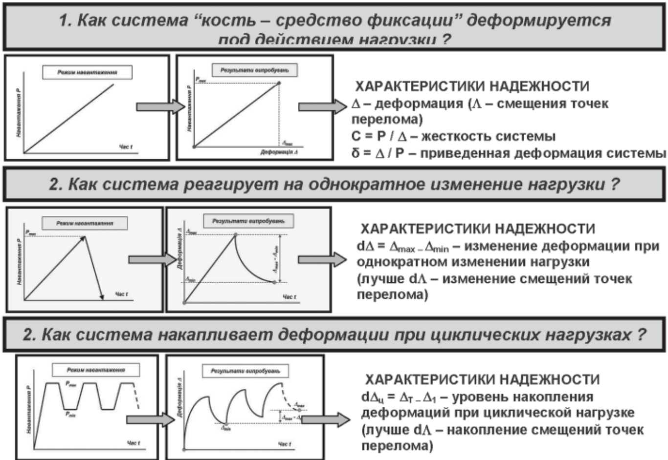
Рис. 2. Основные вопросы надежности систем остеосинтеза и способы испытаний
