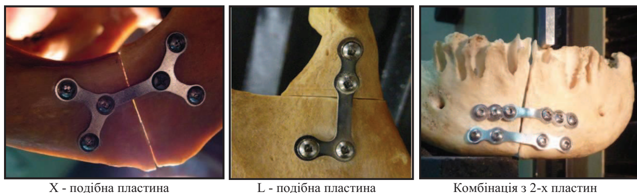
Рис. 2. Типи пластин та схеми закріплень, що використовували.
