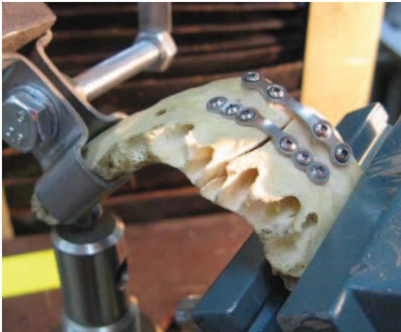
Рис. 3. Схема навантаження та вимірювання деформацій при випробуваннях систем фіксації переломів нижньої щелепи
