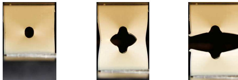
Рис. 3 – Руйнування зразку поліпропілену з круглим концентратором
