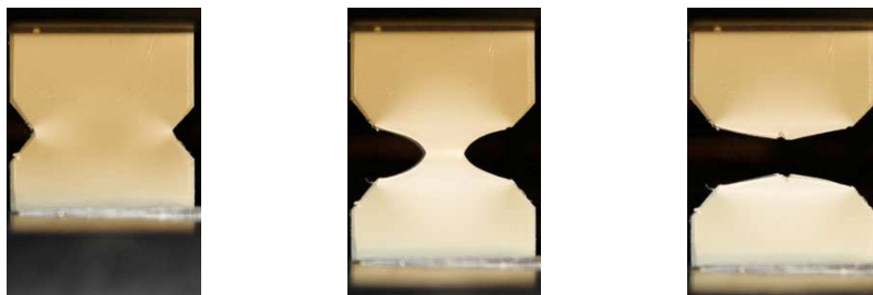
Рис. 2 – Руйнування зразку поліпропілену з V-подібним концентратором
