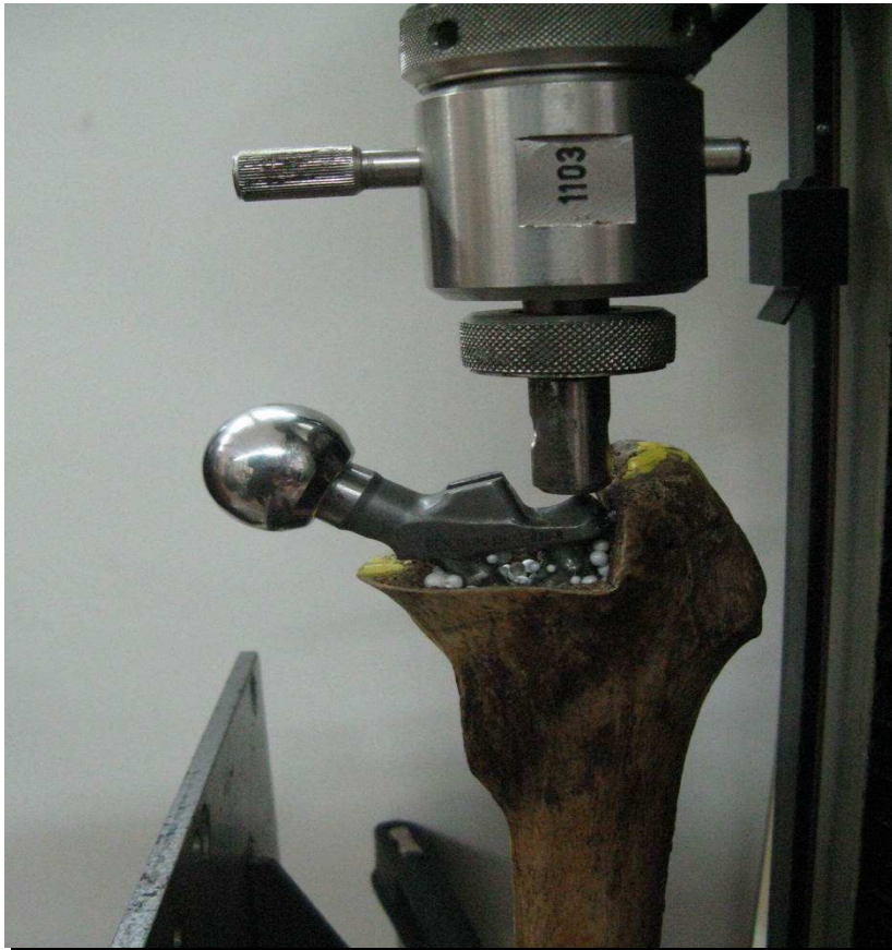
Рис.15 Випробування зразка на стиск
