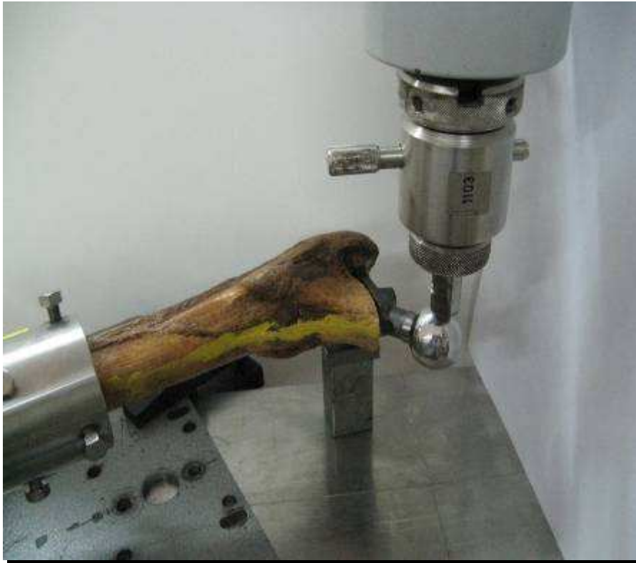
Рис.11 Випробування зразка на кручення
