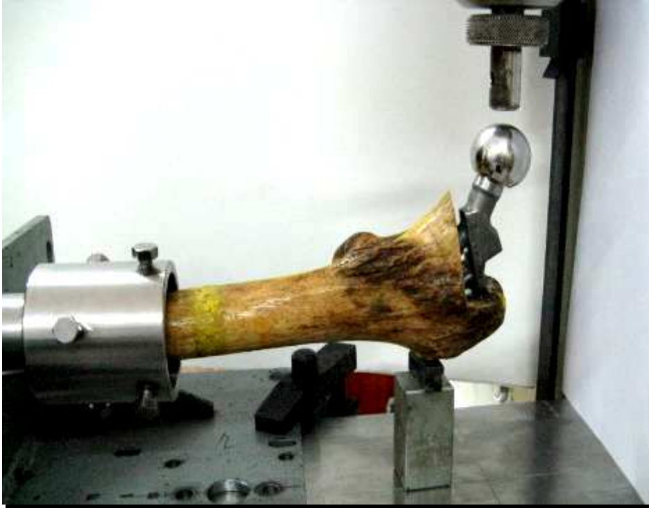
Рис.9 Випробування зразка на згин
