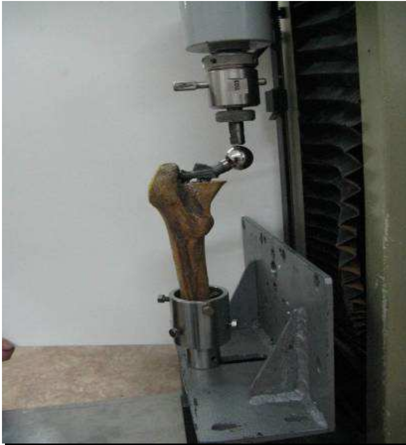
Рис.13 Випробування зразка на стиск
