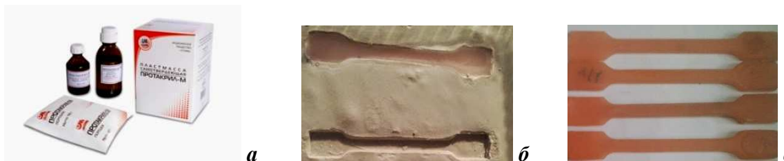
Рис. 1. Компоненти пластмаси (а), заливка пластмаси у форми (б), готові зразки (в)
