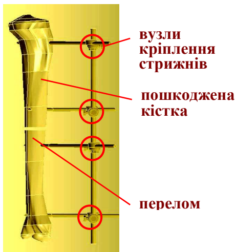
Рис. 1. Конструкція стрижневого апарата фіксації перелому кісток Рис. 2. Звичайний (а) та запропонований (б) вузол кріплення стрижнів в СтАЗФ
