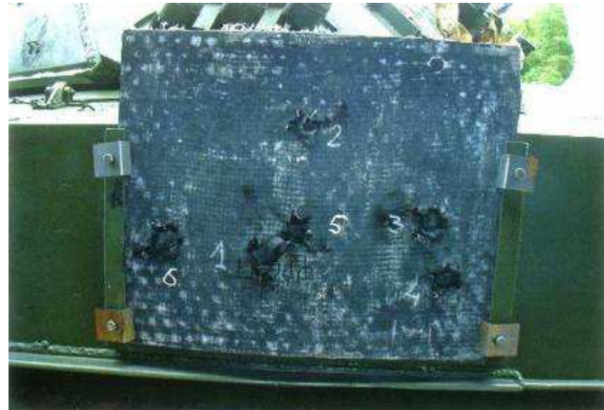
Випробування керамічної бронепанелі для підсилення захисту БМД-4М
