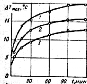
Рис. 2. Изменение избыточной температуры рулонов при диссипативном разогреве в режиме вынужденных поперечных колебаний: 1— H=1,25 Н; 2— H=1,10 Н; 3— H=1,0 Н.
