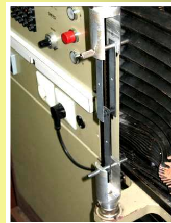
Випробування гум на зсув
